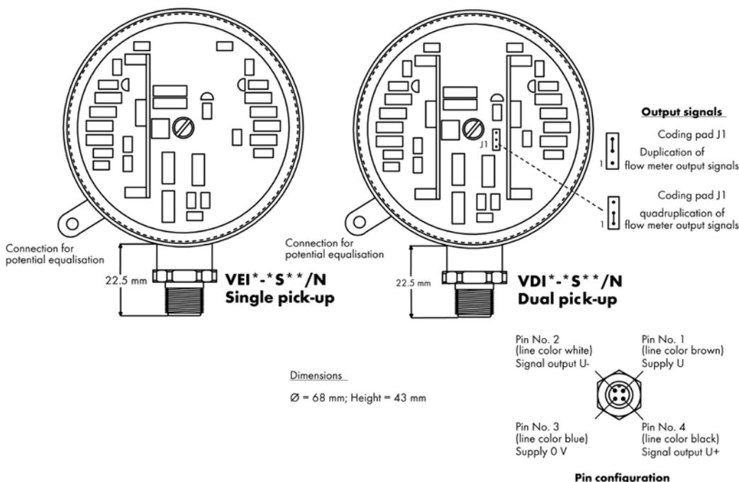
**ELECTRONIC CONNECTION DATA FOR VEI<sup>\*\*</sup>-S<sup>\*\*</sup>/N SINGLE PICK-UPS, VDI<sup>\*\*</sup>-S<sup>\*\*</sup>/N DUAL PICK-UPS**
